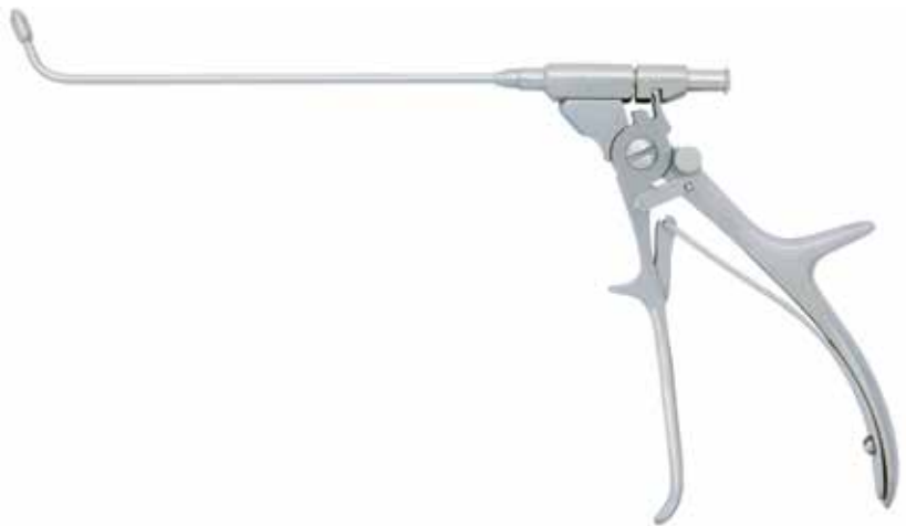
234603FX Circular Cutting Punch , 70° upcurved, with flush connector, WL 13 cm, Ø 3.5 mm Rundkopfstanze , 70° aufgebogen, mit Spülanschluss, NL 13 cm, Ø 3,5 mm
